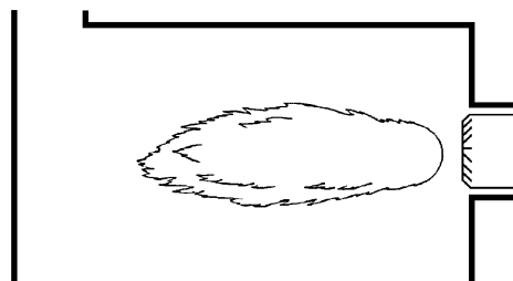
СХЕМА 6-2 - Настройка длины пламени
